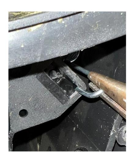
USING LONG NOSED PLIERS PULL THE SPRING SO IT CAN BE LOCATED ONTO THE SELF DRIVE GEARBOX
