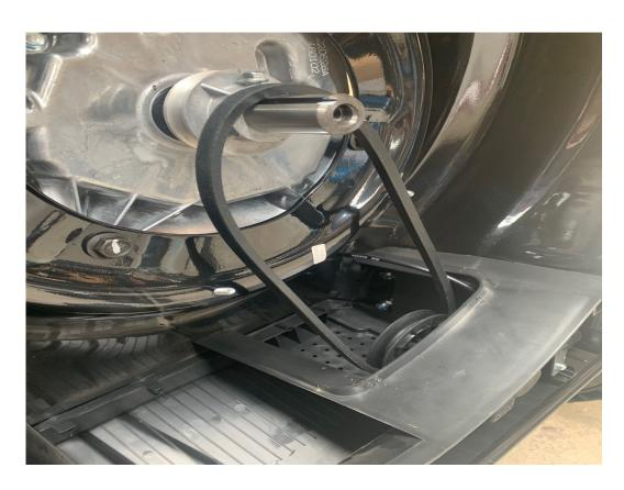
REMOVE THE BELT FROM DRIVE PULLEY
