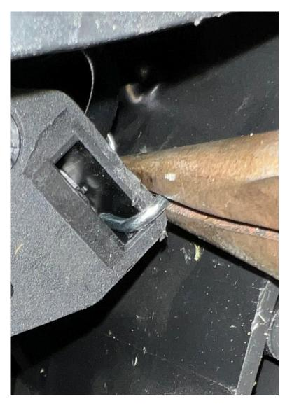
LOCATE THE HOOK OF THE SPRING ONTO POINT ON THE SELF DRIVE GEAR BOX AS SHOWN
