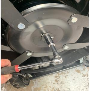
REFIT THE BLADE SUPPORT AND BLADE DISC
